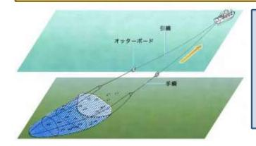
底引き網・・・・左図のように船で海底の魚を獲る漁 法。「オッターボード」で網を左右に、 網口には「浮き」と「おもり」がつ いていて、上下に網を開きます。
